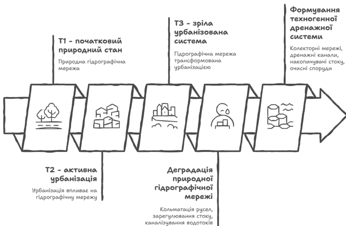
Рис. 2. Просторово-часова трансформація гідрографічної мережі під впливом урбанізації
